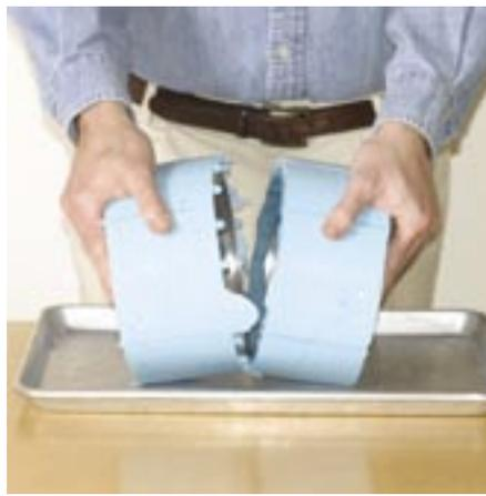
**38. Separate the mold halves.**
