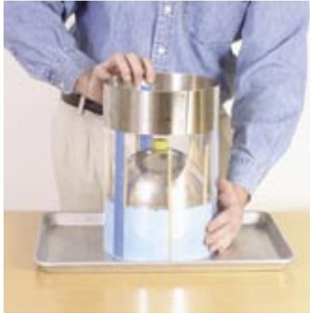
**32. Reassemble the mold box.**
